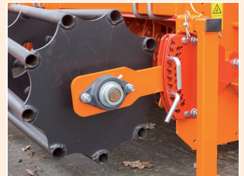
Mit Zapfenverbindung verstellbare Stabwalze
