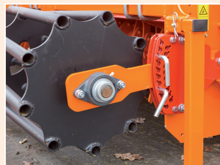
Rouleau d'émottage avec réglage par tenon-mortaise
